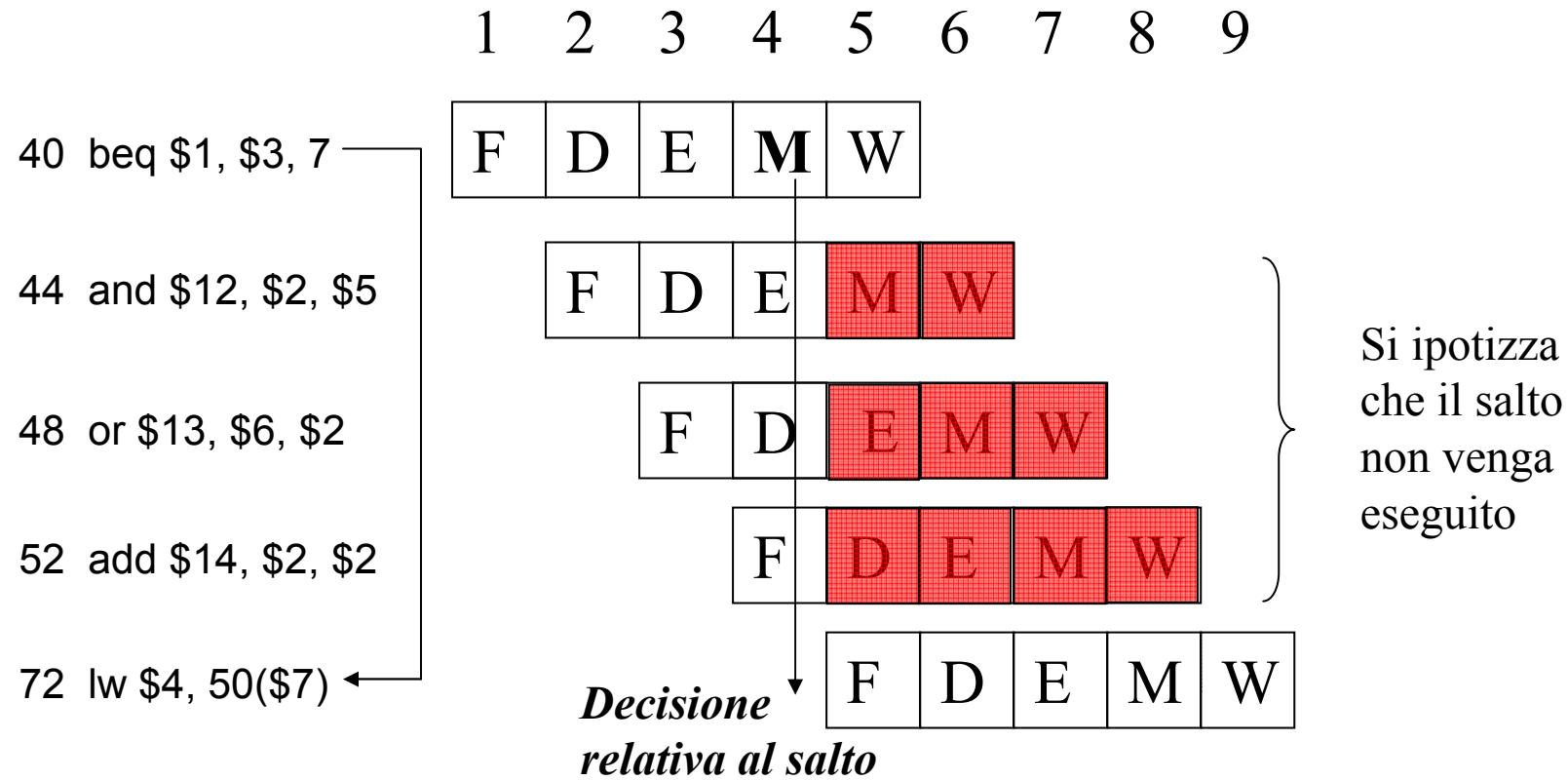
Se il salto viene effettuato [previsione errata], le istruzioni 44, 48, 52 vanno scartate, si introduce un ritardo di 3 cicli di clock.
