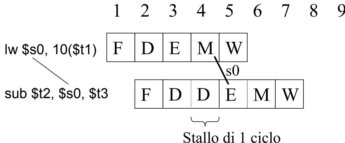
⇒ Ogni volta che una load è seguita da un'istruzione che ne utilizza il dato, ho un ciclo di clock addizionale
