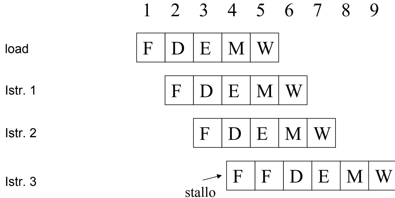
L'istruzione 3 viene completata alla fine del ciclo 9, nessuna istruzione viene completata nel ciclo 8
