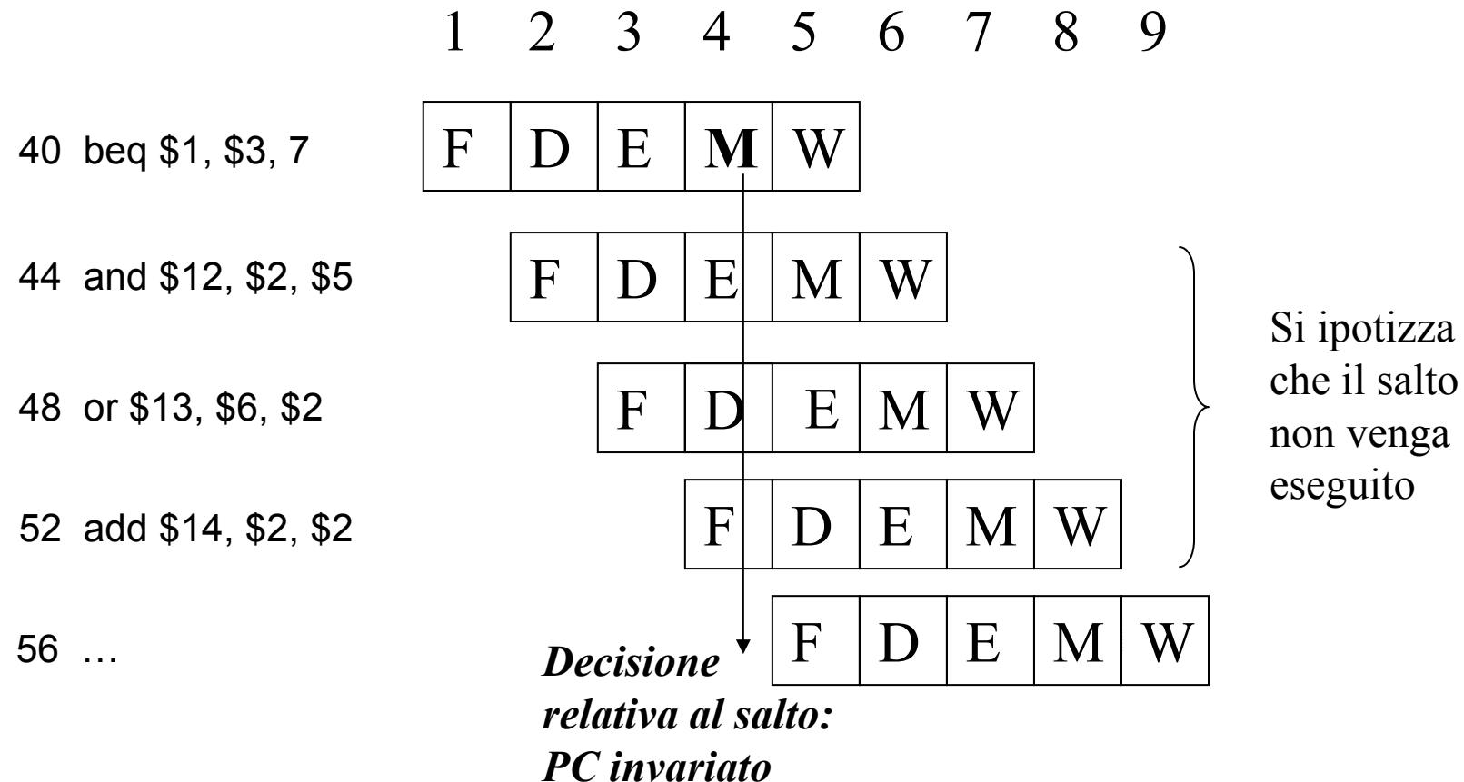
Se il salto viene effettuato [previsione errata] nel ciclo di clock 4 è aggiornato PC [caricamento nuova istruzione di destinazione al ciclo di clock successivo]
