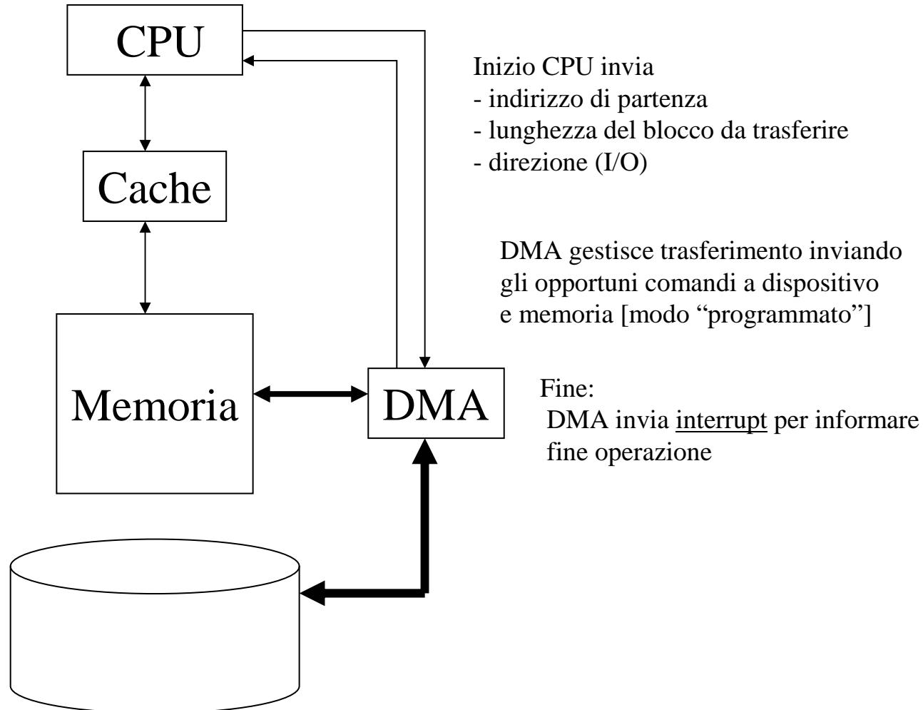
Il processore non è impegnato nell'acquisizione del singolo dato
