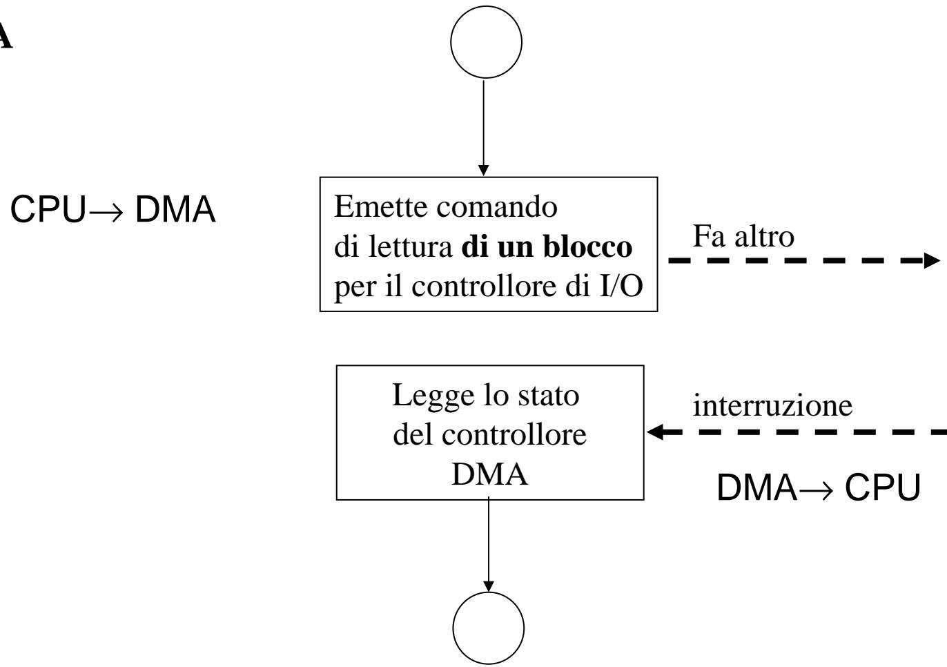
NB: processore dialoga con DMA come con un normale dispositivo I/O;
